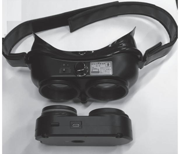
図 2. 今回の新たなフレンツェル眼鏡用小型赤外線眼振装置
