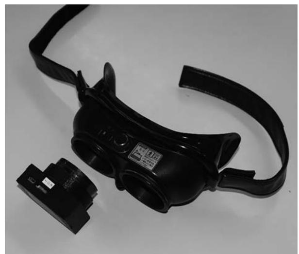
図 1. 前回のフレンツェル眼鏡用小型赤外線眼振撮影装置
